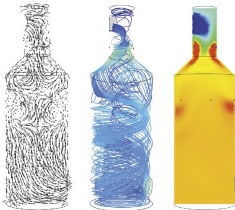
Slika prikazuje tokovno in temperaturno polje v zgovalni komori sežigalnice odpadkov. Ob odprtinah za dovod zraka, kjer je zgorevanje najintenzivneje, opazimo najvišje temperature.
