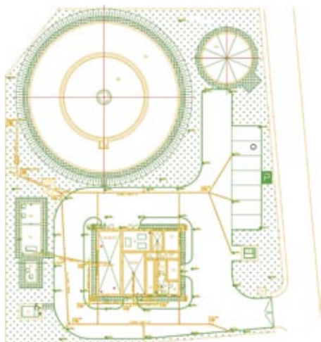
CČN Kranjska Gora (9.000 PE) klasična pretočna naprava z možnostjo simultane nitri/denitrifikacije ali intermitentnega obratovanja in aerobno stabilizacijo blata. Naprava je v obratovanju in dosega večji učinek čiščenja od projektiranega.
