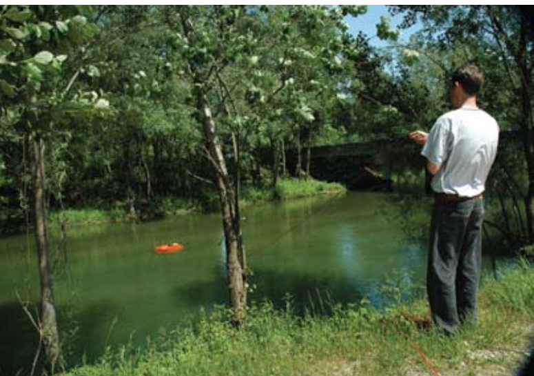
Slika 3: Merjenje pretokov z ADCP merilnikom.
